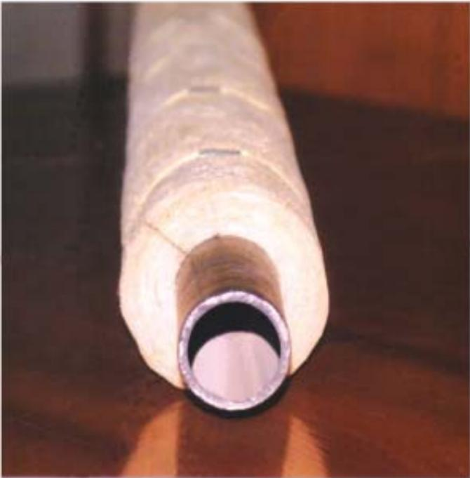
ملافه پیچی راهم می توان گفت عایق کاری است ،ولی عایق باید ضخامت داشته باشد .
