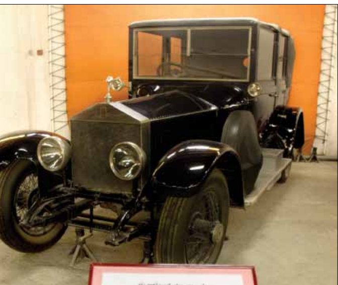
رولزرویس احمد شاه: مدل رولزرویس احمدشاه سیلور گوست بود. این خودرو مجهز به یک موتور شش سیلندر خطی با حجم هفت لیتر بود که ۵۰ اسب بخار قدرت تولید می‌کرد. یعنی تنها کمی کمتر از پراید البته حجم موتور این خودرو هفت برابر پراید است، با این همه تولید این خودرو با این موتور در آن سال‌ها یعنی ۱۹۱۰ غوغایی به پا کرد؛ چرا که خودرو بسیار نرم کار می‌کرد. این خودرو با آن موتور می‌توانست تا سرعت ۸۰ کیلومتر سرعت بگیرد. این خودرو پیش از انقلاب برای بازسازی به انگلستان فرستاده شد اما بازسازی خودرو طول کشید و انقلاب رخ داد، خانواده پهلوی مدعی مالکیت خودرو بود اما پس از تشکیل دادگاه خودرو به ایران بازگردانده شد.
